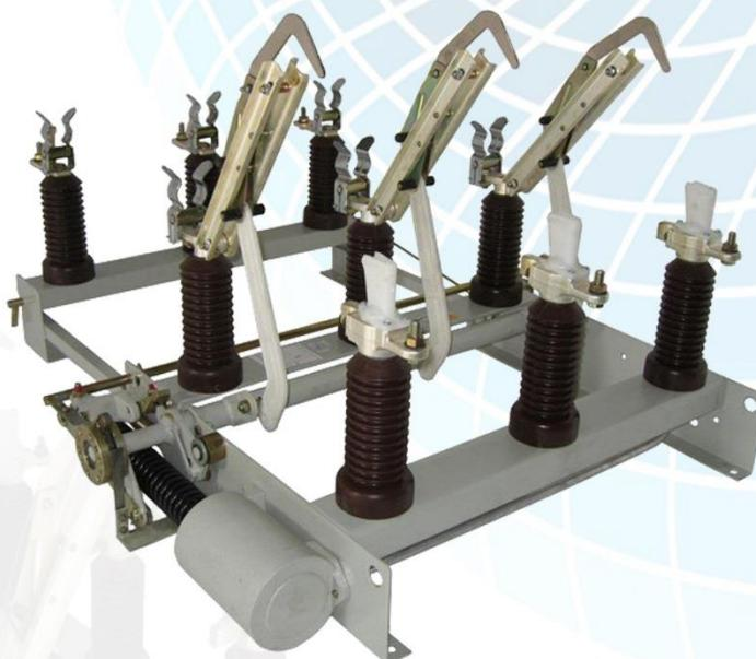
فیوزها یک فریم پایه که به محور سکسیونر وصل است، نصب می‌شوند. روی این فریم پایه، مقره‌ها و کنکات‌ها نیز نصب می‌شوند.
